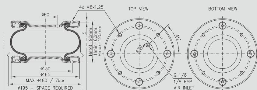
On request, the air inlet thread may be changed to M10x1; possibly, its placement may be changed. / Závit na přívodu vzduchu na požadání můžno změnit na M10x1, příp. změnit jeho umístění. / Резьбу на входе воздуха, по требованию, можно изменить на M10x1 или же изменить место расположения входа.
