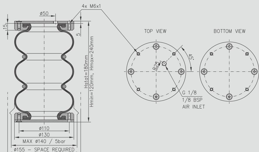
On request, the air inlet thread may be changed to M10x1; possibly, its placement may be changed. / Závit na přívodu vzduchu na požadání můžno změnit na M10x1, příp. změnit jeho umístění. / Резьбу на входе воздуха, по требованию, можно изменить на M10x1 или же изменить место расположения входа.
