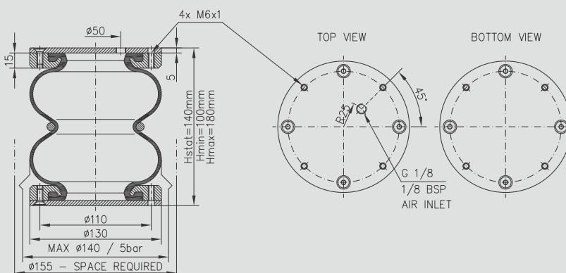
On request, the air inlet thread may be changed to M10x1; possibly, its placement may be changed. / Závit na přívodu vzduchu na požadání můžno změnit na M10x1, příp. změnit jeho umístění. / Резьбу на входе воздуха, по требованию, можно изменить на M10x1 или же изменить место расположения входа.
