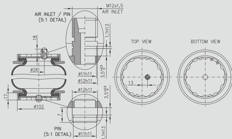
Set is fixed for the pin or combined supply of air. / Komplet fixován za čep resp. kombinovaný přívod vzduchu, zajištěn pojistnými kroužky. / Комплект крепится за палец или же комбинированный подвод воздуха, стопорится стопорными кольцами.
