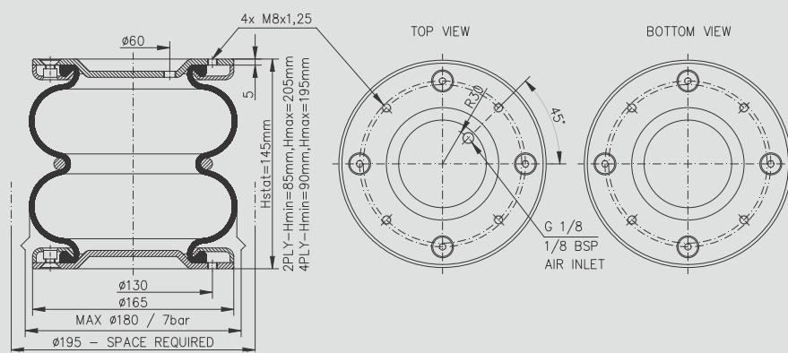
On request, the air inlet thread may be changed to M10x1; possibly, its placement may be changed. / Závit na přívodu vzduchu na požadání může změnit na M10x1, příp. změnit jeho umístění. / Резьбу на входе воздуха, по требованию, можно изменить на M10x1 или же изменить место расположения входа.
