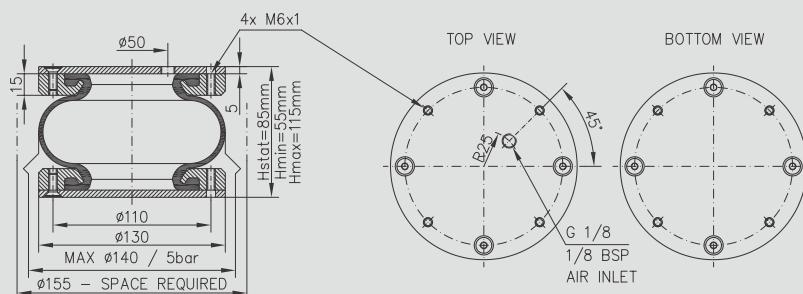
On request, the air inlet thread may be changed to M10x1; possibly, its placement may be changed. / Závit na přívodu vzduchu na požadání můžno změnit na M10x1, příp. změnit jeho umístění. / Резьбу на входе воздуха, по требованию, можно изменить на M10x1 или жеизменить место расположения входа.
